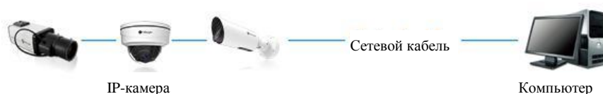
Рисунок 2-1-1. Непосредственное подключение камеры к ПК.
