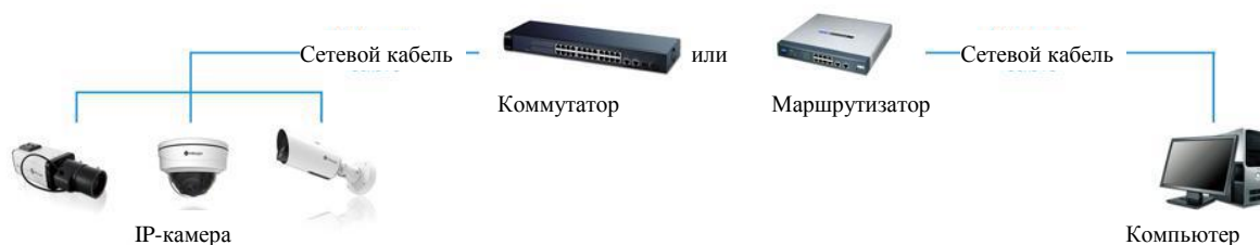
Рисунок 2-1-2 Подключение через коммутатор или маршрутизатор
